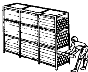
Entreposage de tuyaux
